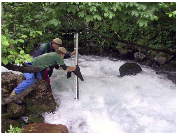
Wasserstandsmessung an einer grossen Karstquelle durch Mitglieder der Höhlenforscher-Gemeinschaft Unterwalden.
